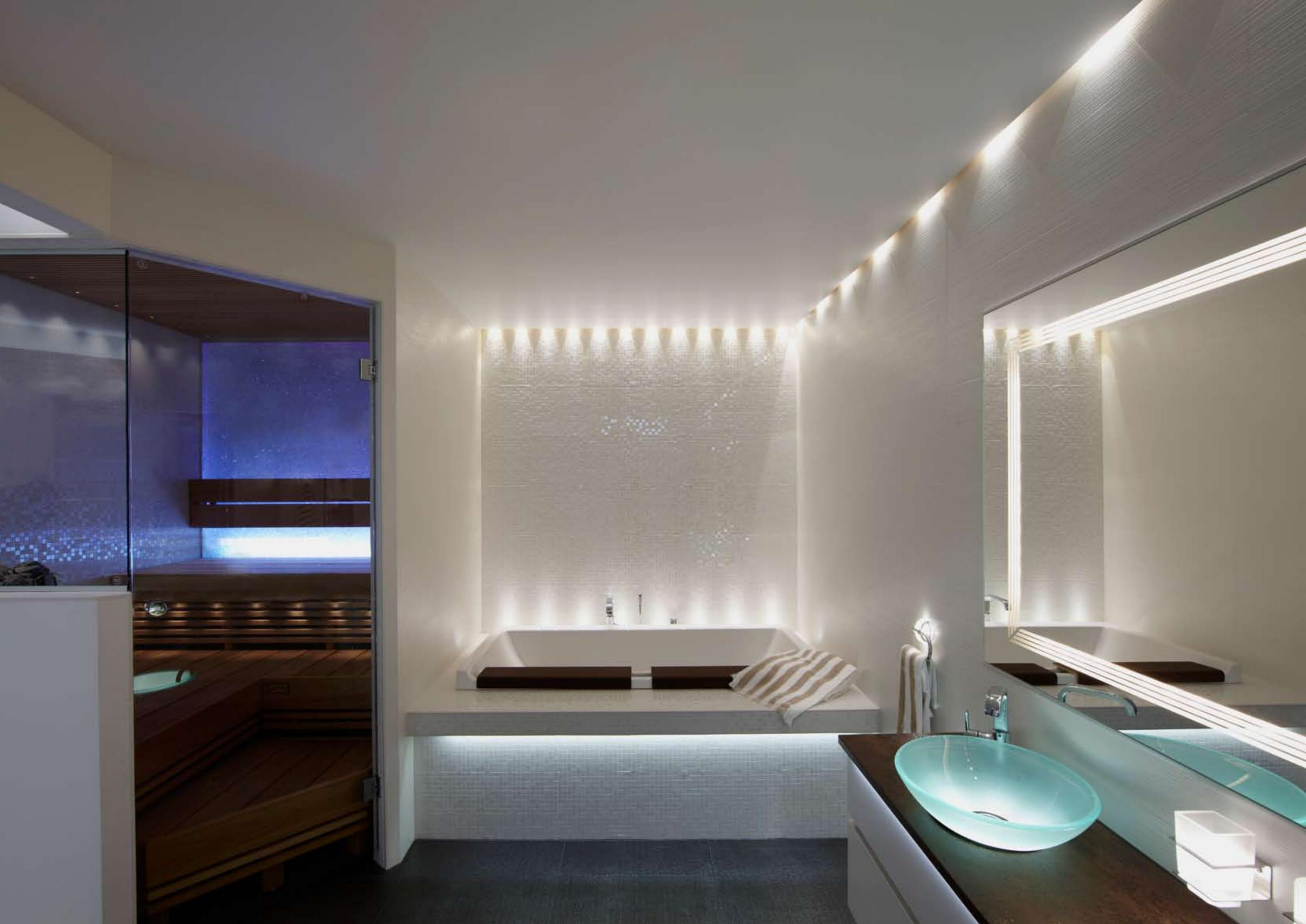
Nämä ledivalaisimet on helppo asentaa, asennusreikä ø 14 mm. Teho 1 W / 350 mA, IP44 Huom! Sarjaan kytkentä.
