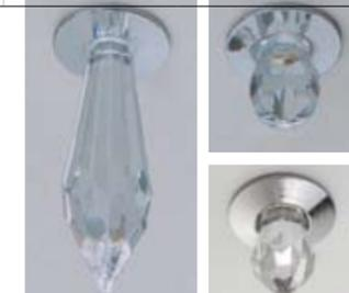
Комплекты Crystal Star включают жгут из пластмассового волокна, в котором кроме тонких (0,75 мм) волокон есть 18 более толстых (3 мм) волокон с хрустальными насадками. В проекторе источником света служит галоген по 75 Вт и он оснащен диском мерцания.
