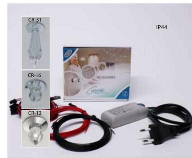
LED - kristallit on helppo asentaa jousilukituksen ansiosta. Asennusreikä ø 14 mm. Kiinnitysalustan minimiainevahvuus 6 mm. Teho 1 W /350 mA, IP44. Huom! Sarjaankytkentä.
